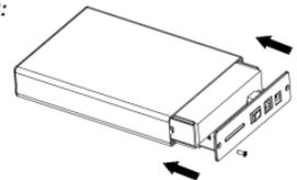
Verbinden Sie nun vorsichtig Ihre 8,89cm/3,5“-SATA-Festplatte (Festplatte nicht im Lieferumfang enthalten) mit dem passenden Anschluss des PCB-Interface. Schieben Sie nun das PCB-Interface samt der Festplatte in das Gehäuse und befestigen Sie das Interface mit den Schrauben.
