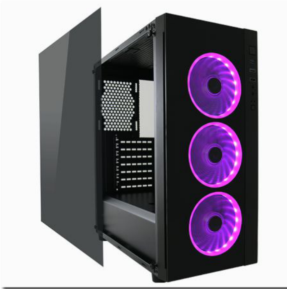
- Frontpanel aus Hartglas; Seitenteil aus Acrylglas
