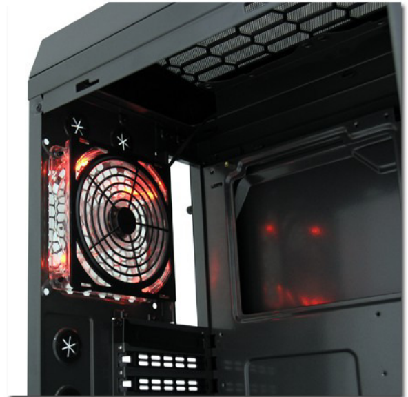
- inkl. drei rot beleuchteter 120mm-Lüfter (bis zu acht Gehäuselüfter montierbar)
